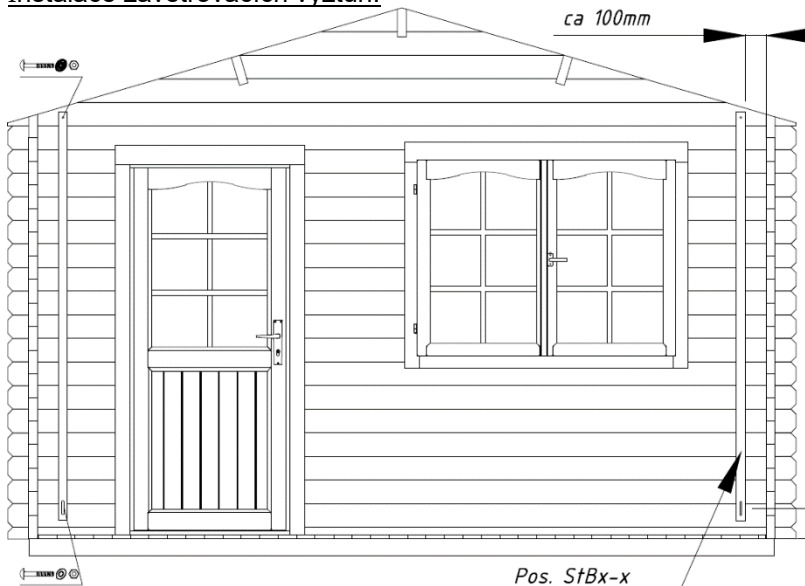
Instalace zavětrovacích výztuh:
