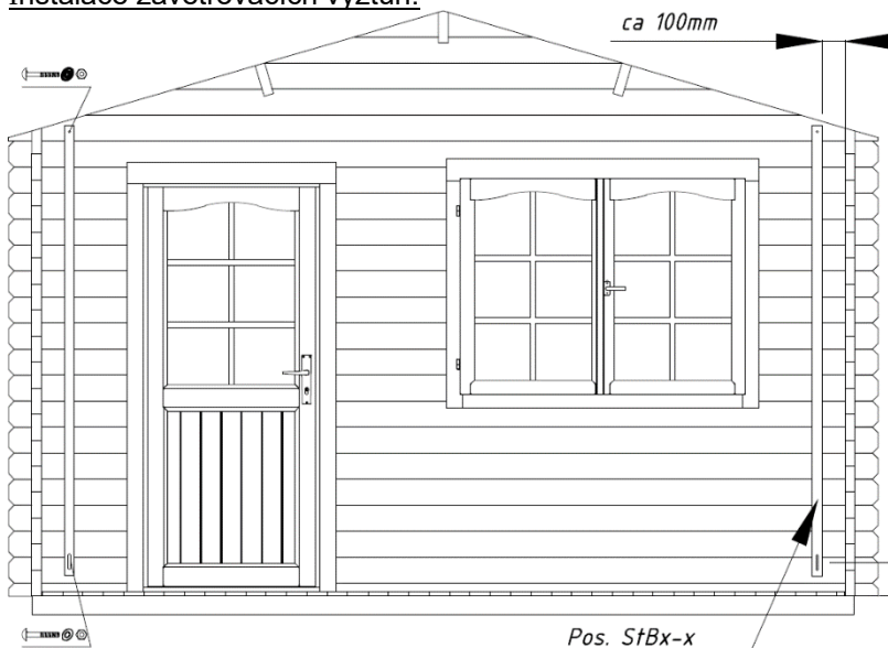
Instalace zavětrovacích výztuh:
